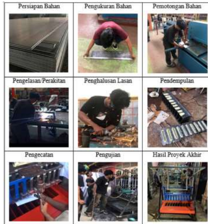
Gambar 2. Proses Pembuatan Alat Pencetak Batako
