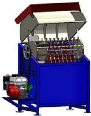
Gambar 2. Rancangan Utuh Mesin Perontok Sistem Lorong Hembus
